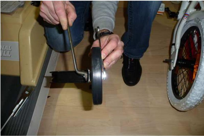
Mutter von der Gegenseite aufstecken, kontern und mit passendem Ringschlüssel festziehen
