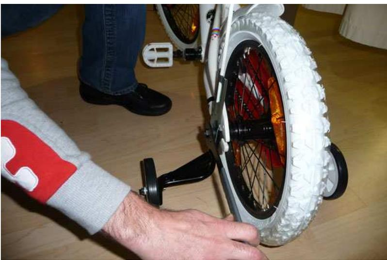
Stützrad mit Beilagscheibe und Schraube befestigen.
