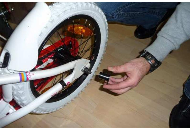
Nehmen Sie die Schutzkappe an der Hinterachse ab
