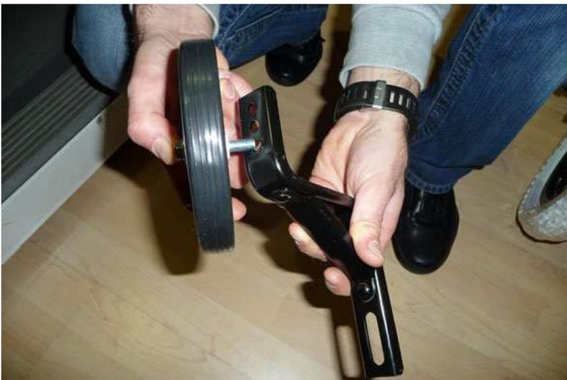
Schraube durch das Rad und dann in eine passende Lochöffnung des Metallwinkels von aussen stecken.
