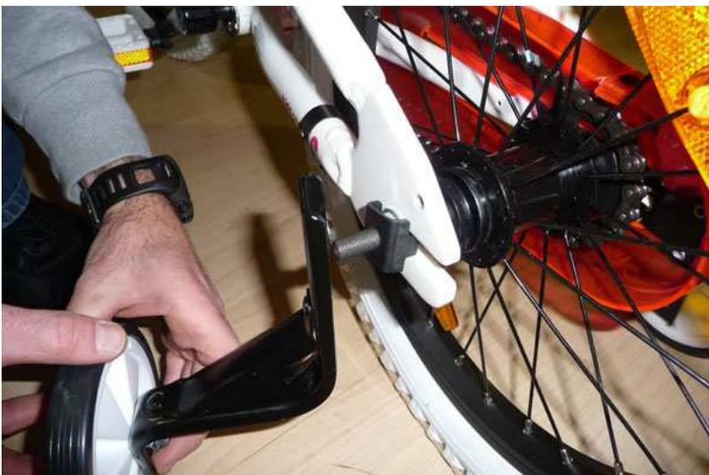
Metallwinkel mit dem Stützrad auf die Achse schieben
