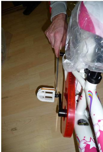
Die Pedale haben eine Kennzeichnung für in Fahrtrichtung gesehen rechts (R) und links (L). Vor der Montage fetten Sie die Gewinde bitte ein. Drehen Sie nun von Hand das rechte Pedal im Uhrzeigersinn an den rechten Kurbelarm. Schrauben Sie entsprechend das linke Pedal entgegen dem Uhrzeigersinn an den linken Kurbelarm.
