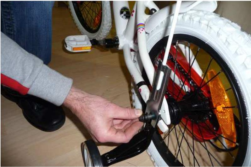
Fahnenende auf die Achse stecken
