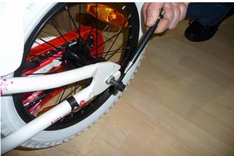
Schrauben Sie die Mutter und Beilagscheibe von der Hinterachse ab
