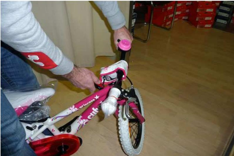
Benutzen Sie das Mini-Tool und ziehen Sie die Schrauben der Vorbauklammer fest.
